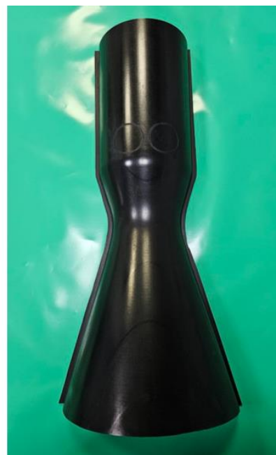
Рисунок 2- Пример готовой оснастки с использованием гелькоута СР200
