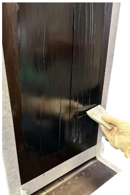
Рисунок 1– Нанесение гелькоута CP200 на углепластиковую мастер-модель силиконовым шпателем
