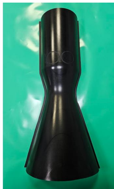
Рисунок 2– Пример готовой оснастки с использованием гелькоута CP200
