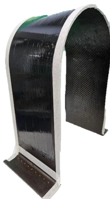
Рисунок 1- Нанесение гелькоута CP200C на углепластиковую мастер-модель силиконовым шпателем
