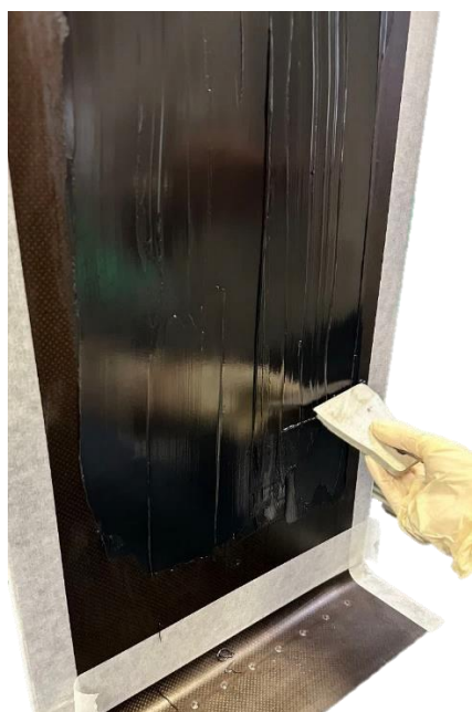
Рисунок 1- Нанесение гелькоута CP200C на углепластиковую мастер-модель силиконовым шпателем
